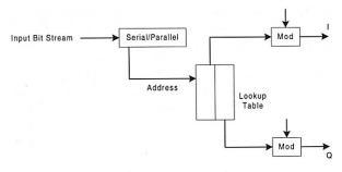
Fig.2 QAM Mapping
